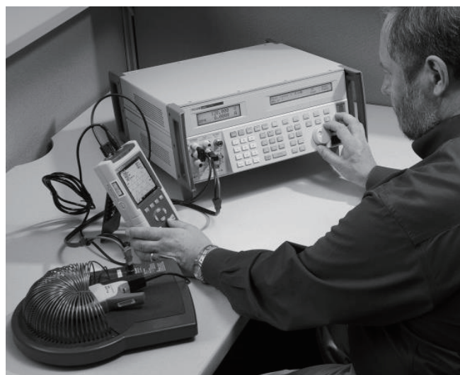
Fluke Calibration 5522A 多产品校准器正在校准福禄克电能质量分析仪
